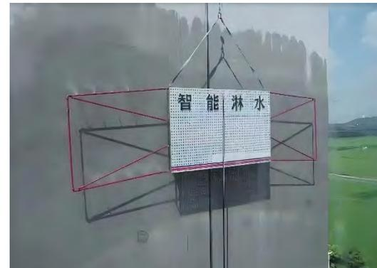
建筑外墙防水淋水试验
